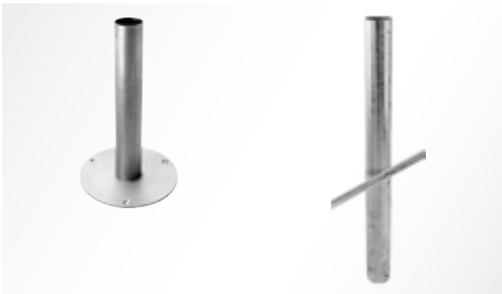
Voor de versie KHA SLIM 220 kan de bevestiging aan de vloer gemaakt worden met gebruik van een pen van verzinkt staal die rechtstreeks in het cement gemetseld moet worden, of een basis van rvs die met pluggen (inbegrepen) aan de vloer bevestigd moet worden, beide leverbaar als accessoires
