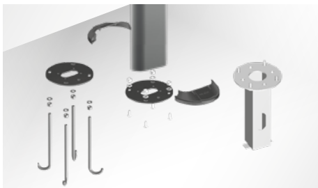
Voor de installatie is als accessoire een roestvrijstalen grondplaat verkrijgbaar voor verankering in cement
