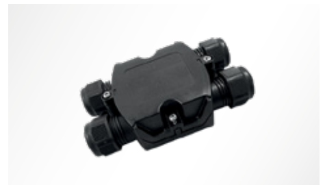
Elektrische verbinding met snelconnector, gemaakt van PA66 zonder halogenen en fosfor, met contacten van verzilverd koper, voor kabels \varnothing 9 - \varnothing 14 mm
